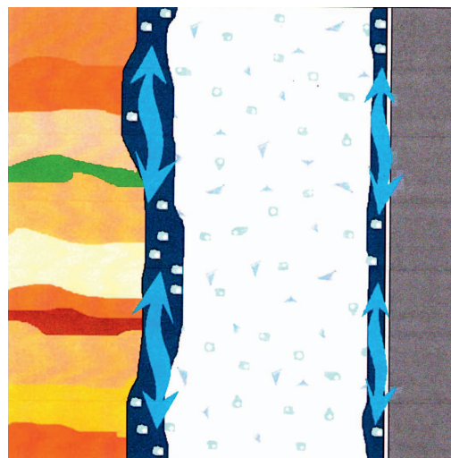
Rys. 3. Brak związania zaczynu cementowego z formacją skalną
