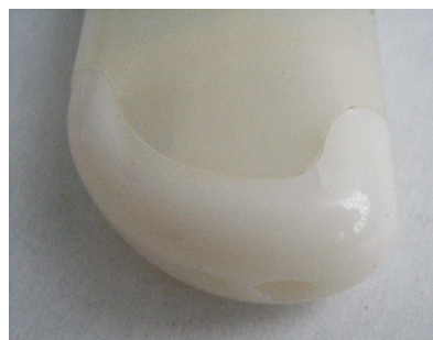
Fot. 2. Kształt podstawy utrudniający uruchomienie zapalniczki
