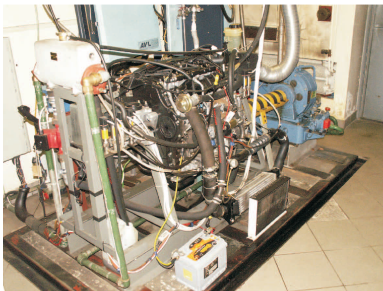
Rys. 1. Widok stanowiska badawczego z silnikiem Ford 1.8L Duratec-HE PFI FFV (125PS) MI4 [INiG]
