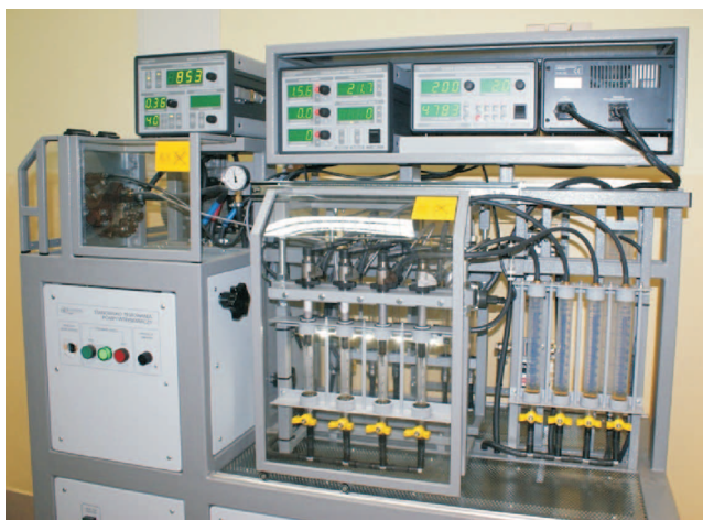
Fot. 1. Widok ogólny stanowiska do testowania pomp i wtryskiwaczy systemów Common Rail STPiW – 2 produkcji Autoelektronika Kędzia (fot. autor)
