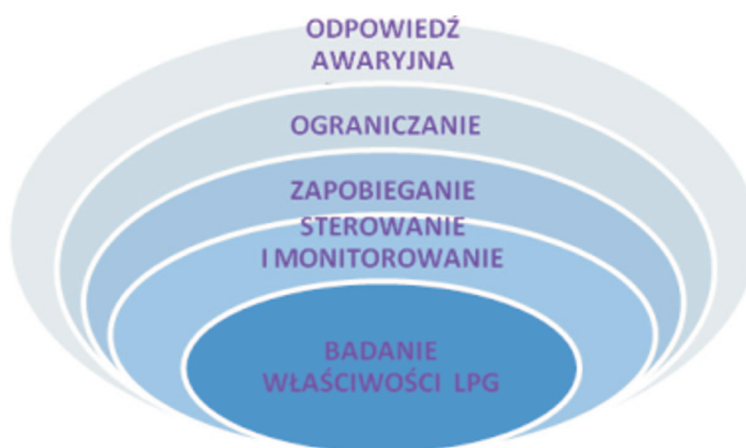
Rys. 3. Warstwy zabezpieczeń procesu badań LPG w ujęciu zapisów normy PN EN 61511
