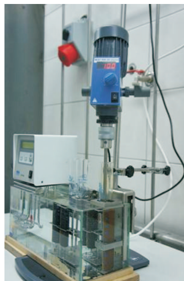
Rys. 2. Badania skuteczności deemulgowania w układach ropa naftowa–woda morska
