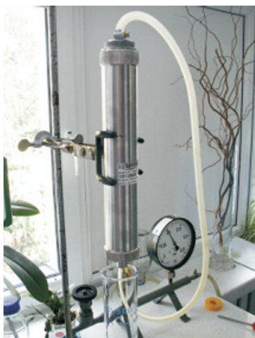
Fot. 1. Aparat do testów zgodnie z ISO 13357
