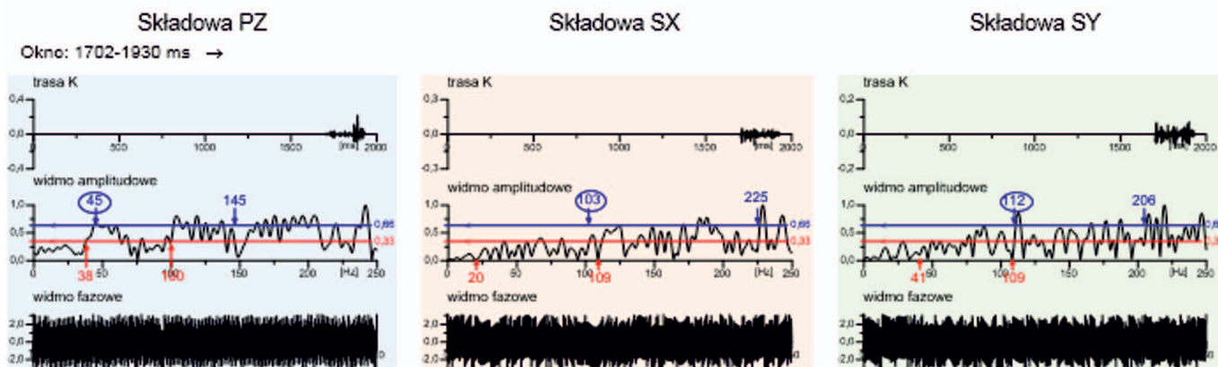
Rys. 7. Charakterystyki spektralne krzywych refleksyjności obliczonych z profilowania prędkości fal podłużnych i poprzecznych w odwiercie L-1 w wybranych interwałach czasowych
