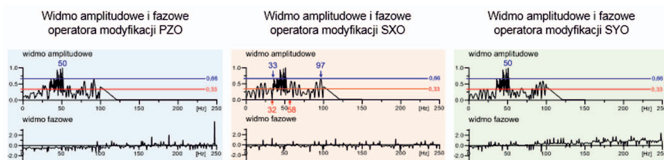
Rys. 8. Charakterystyki spektralne operatorów modyfikacji obliczonych na podstawie analizy danych otworowych fal podłużnych i poprzecznych
