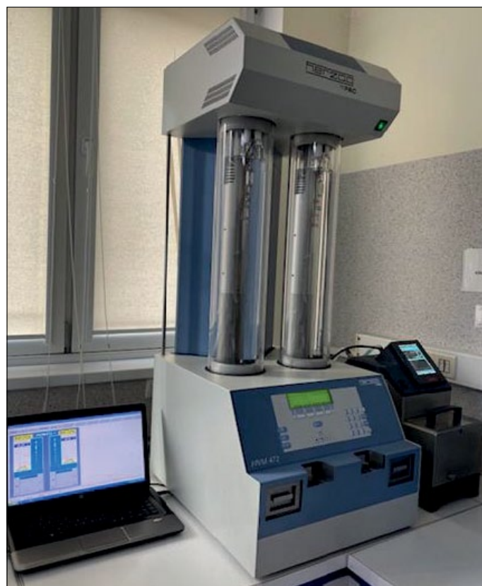
Rysunek 2. Zestaw do wykonywania pomiarów lepkości kinematycznej: lepkościomierz HVM 472 + ministat
