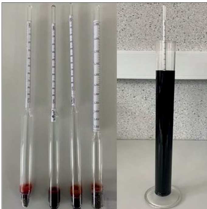
Rysunek 1. Z lewej strony – areometry wykorzystywane do pomiaru gęstości. Z prawej strony – szklany cylinder uzupełniony badaną cieczą z zanurzonym areometrem
