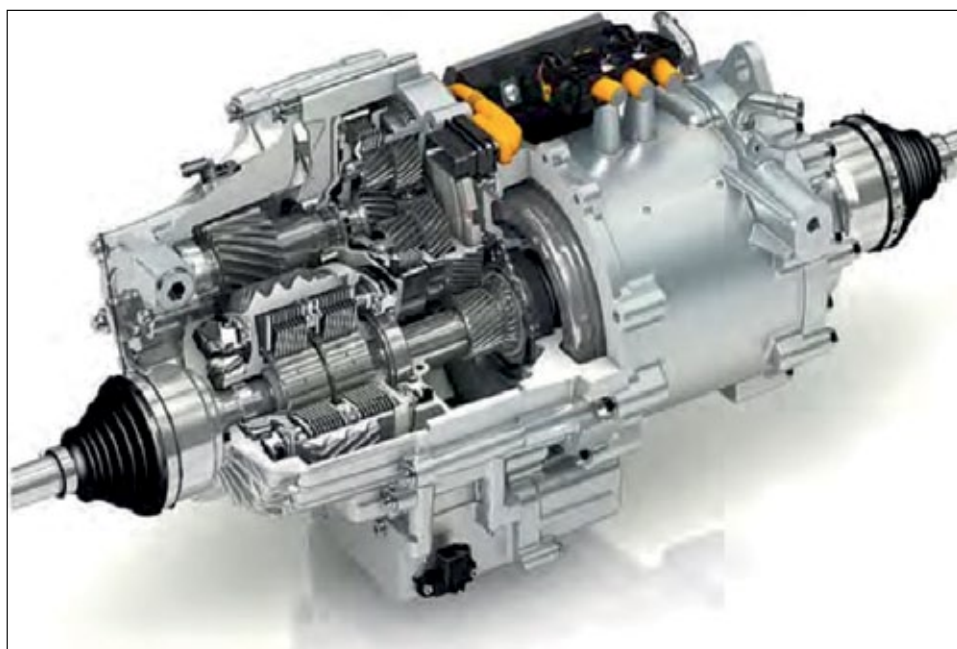
Rysunek 4. Czterostopniowa i dwubiegowa przekładnia pojazdu elektrycznego – maksymalne przełożenie 20 (Babula i Pietruszczak, 2017)
