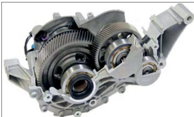
Rysunek 3. Dwustopniowa i jednobiegowa przekładnia pojazdu elektrycznego o przełożeniu 12,5 (Giakoumis i Zachiotis, 2017)
