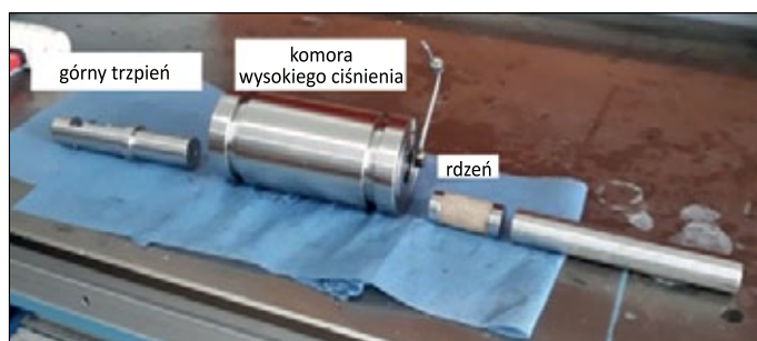
Rysunek 1. Widok komory wysokiego ciśnienia, rdzenia i trzpieni przed montażem i usadowieniem rdzenia w komorze
