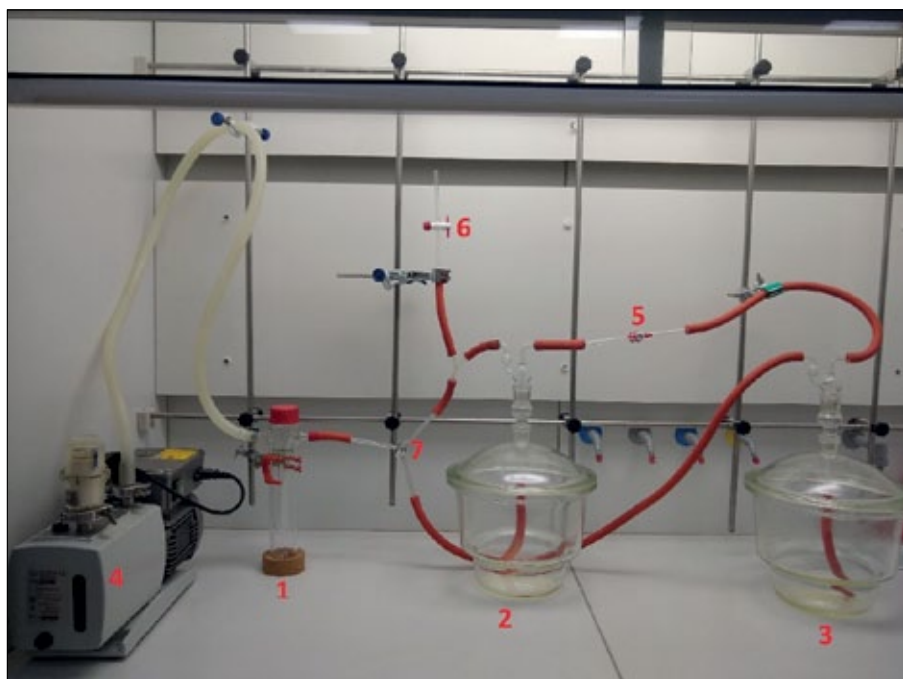
Rysunek 3. Zestaw do nasycania próbek: 1 – oddzielnik do zapobiegania przedostawaniu się cieczy do pompy próżniowej; 2 – zbiornik cieczy nasycającej; 3 – naczynie do nasycania próbek cieczą; 4 – pompa próżniowa; 5 – zawór odcinający; 6 – zawór odcinający do pompy próżniowej i do napełniania układu powietrzem atmosferycznym; 7 – zawór trójdrożny
