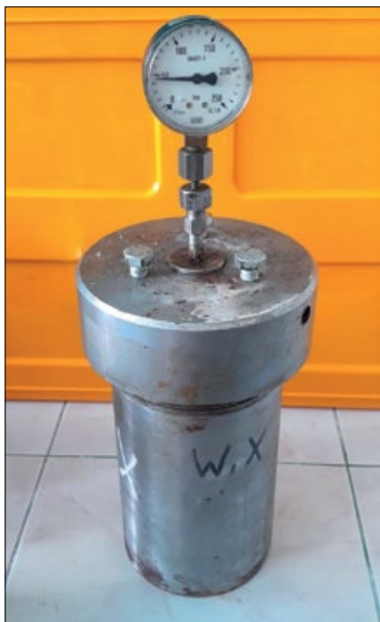
Rysunek 4. Przykładowy autoklaw do przechowywania próbek kamieni cementowych pod ciśnieniem
