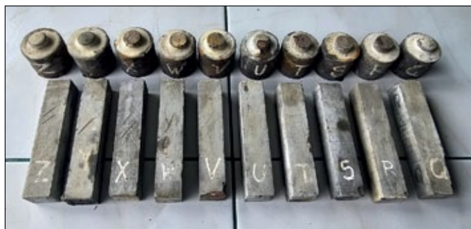
Rysunek 5. Próbkę o symbolach od Q do Z wyjęte z autoklawów po 9 miesiącach deponowania
