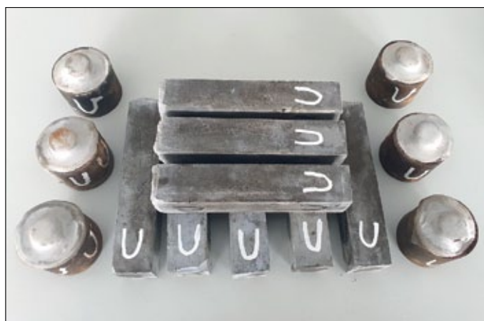
Rysunek 3. Przykładowe próbki stwardniałych zaczynów cementowych przeznaczone do badań wytrzymałościowych
