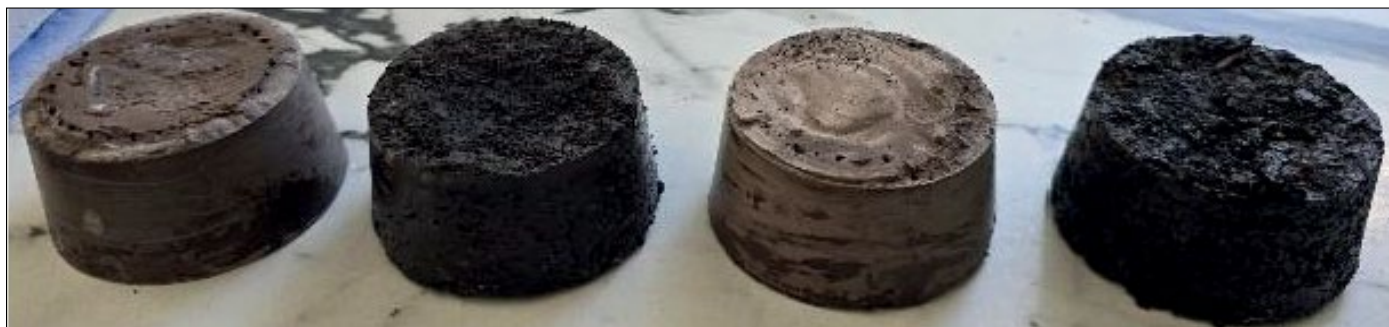
Rysunek 8. Zestalone próbki z dodatkiem spoiwa hydraulicznego, w/c = 0,6
