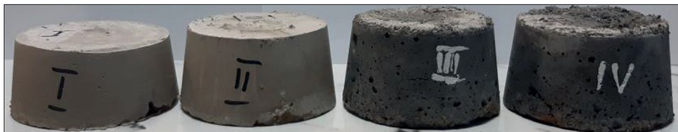
Rysunek 7. Zestalone próbki na osnowie zaczynu cementowego o w/c = 0,6
