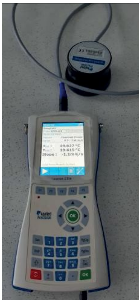
Rysunek 4. Aparat ISOMET 2114 do pomiaru przewodności cieplnej z sondą powierzchniową
