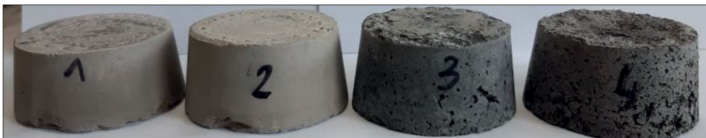
Rysunek 6. Zestalone próbki na osnowie zaczynu cementowego o w/c = 0,5
