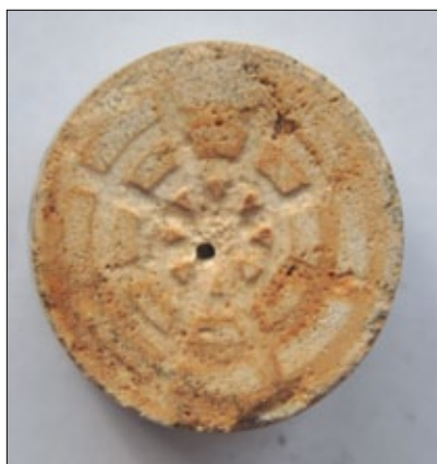
Rysunek 9. Powierzchnia wlotowa rdzenia C po kwasowaniu mieszaniną kwasów, związków chelatujących i alkoholi
