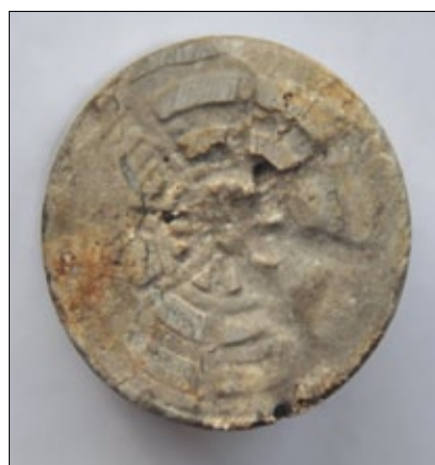
Rysunek 12. Powierzchnia wlotowa rdzenia D po kwasowaniu mieszaniną kwasów, związków chelatujących i alkoholi
