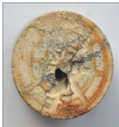
Rysunek 6. Powierzchnia wlotowa rdzenia B po kwasowaniu mieszaniną kwasów, związków chelatujących i alkoholi
