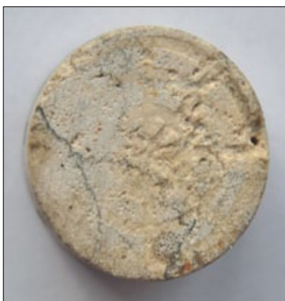
Rysunek 10. Powierzchnia wylotowa rdzenia C po kwasowaniu mieszaniną kwasów, związków chelatujących i alkoholi
