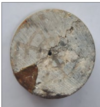
Rysunek 13. Powierzchnia wylotowa rdzenia D po kwasowaniu mieszaniną kwasów, związków chelatujących i alkoholi
