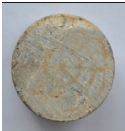
Rysunek 4. Powierzchnia wylotowa rdzenia A po kwasowaniu mieszaniną kwasów, związków chelatujących i alkoholi
