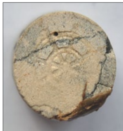
Rysunek 7. Powierzchnia wylotowa rdzenia B po kwasowaniu mieszaniną kwasów, związków chelatujących i alkoholi
