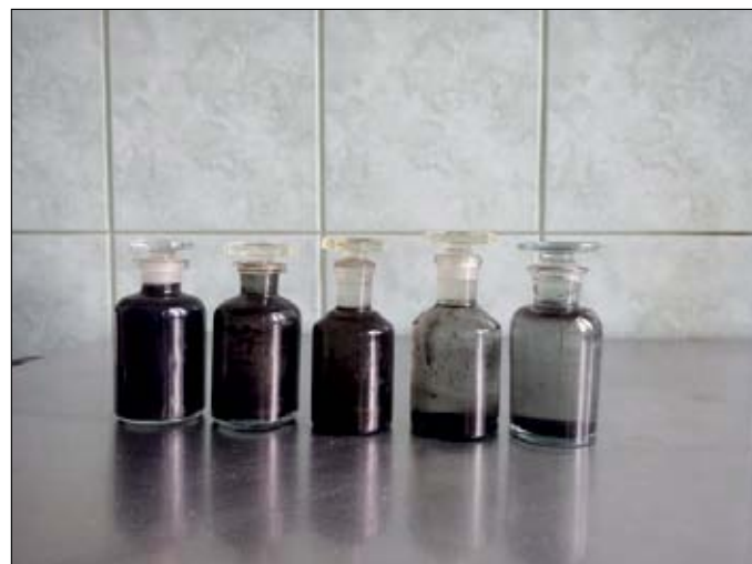
Rysunek 1. Przykładowa hodowla anaerobowych bakterii redukujących siarczany (SRB) – wzrost bakterii w 50-ml butelkach po 30-dobowej inkubacji
