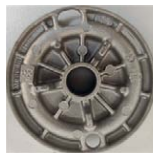
Rysunek 4b. Palnik Y średni – widok pierścienia płomieniowego od dołu
