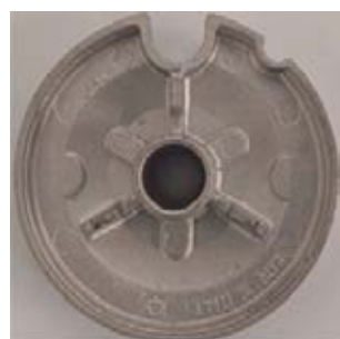
Rysunek 3b. Palnik X średni – widok pierścienia płomieniowego od dołu
