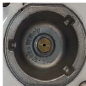
Rysunek 4d. Palnik Y średni – korpus dyfuzora
