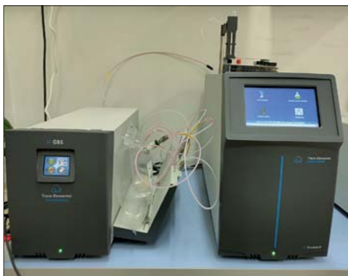
Rysunek 1. Aparatura badawcza do oznaczania zawartości siarki w próbkach gazowych metodą fluorescencji w UV
