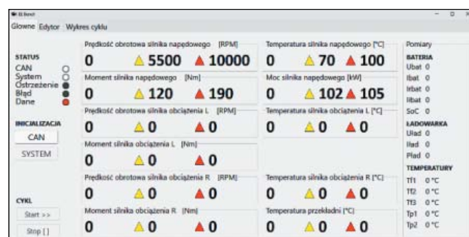
Rysunek 6. Główna zakładka aplikacji z wyświetlonymi blokami funkcjonalnymi programu (fot. INiG – PIB)
