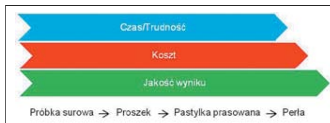
Rysunek 1. Preparatyka próbek do badań XRF
