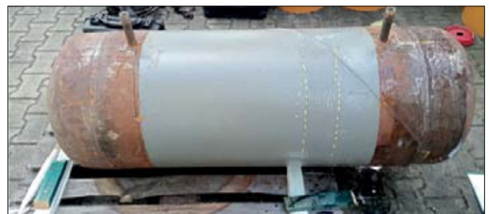
Rysunek 5. Rura zaślepiąca dennicami przygotowana do badań ultradźwiękowych (autor: Piotr Szewczyk)
