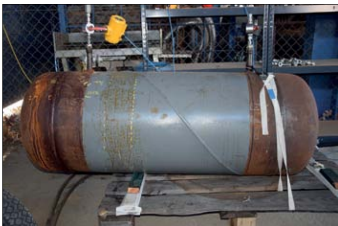
Rysunek 6. Rura zaślepiona dennicami podczas badania oddziaływania wodoru na materiał rury (autor: Piotr Szewczyk)
