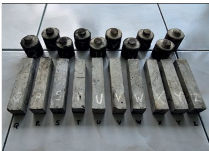
Rysunek 3. Próbki o symbolach od „Q” do „Z” wyjęte z autoklawów po 20 miesiącach deponowania
