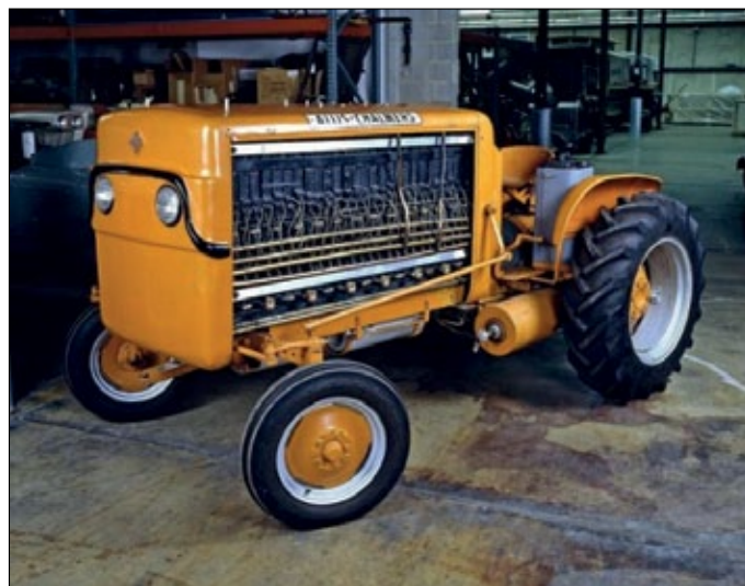
Rysunek 1. Pojazd rolniczy zasilany przez ogniwo paliwowe – lata 50. XX wieku (Źródło: Allis-Chalmers Company, 1959)
