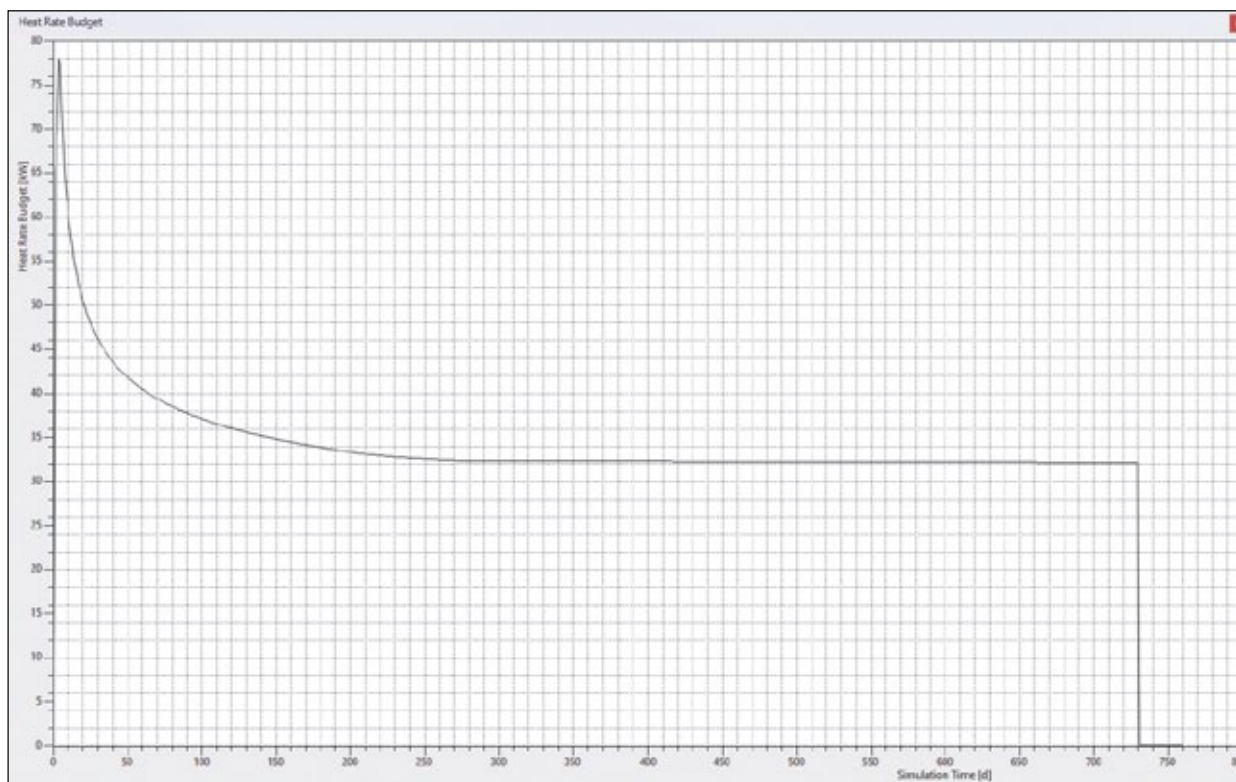
Rysunek 22. Chwilowa moc cieplna wszystkich BHE podczas 730 dni ładowania piaskowca bez przepływu
